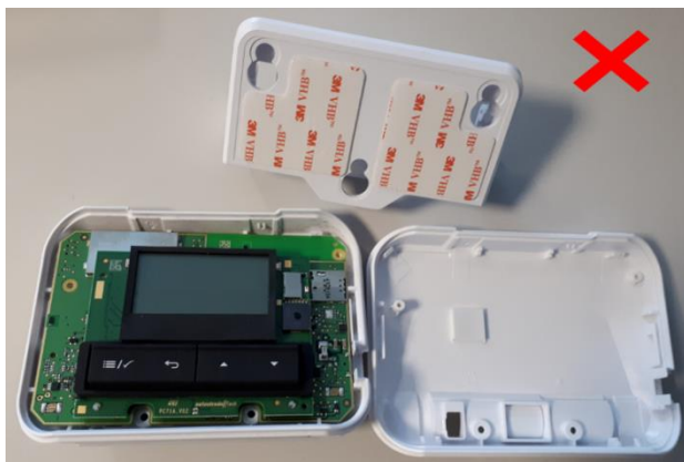
Bild 4 - Beispiel einer beschädigten OBU
